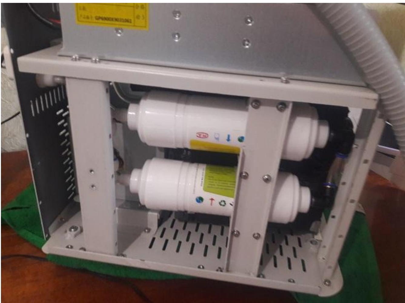
Как правило в аппарате обычно стоит 1 или 2 фильтра для очистки воды. Если Вы давно не меняли воду в аппарате и фильтры это повлечет выход из строя диодной матрицы лазера.
